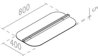
Bodendistanzplatte. Height compensator.
